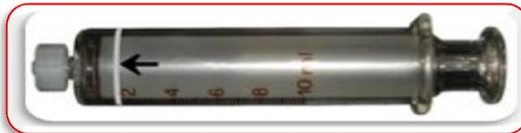
Diese Ganzglasspritze bis 100 mL Volumen wird durch einen auswechselbaren Dichtring (PTFE, oft Teflon genannt) in einer Nut auf dem Glaskolben optimiert. Diese innovative Glasspritze ist gasdicht ( $< 10^{-5}$  mBar Lsec $^{-1}$ ), lösungsmitteldicht (0,3 mg/Tag), temperaturbeständig (-88 - 150 °C), leichtgängig (1 kp).
