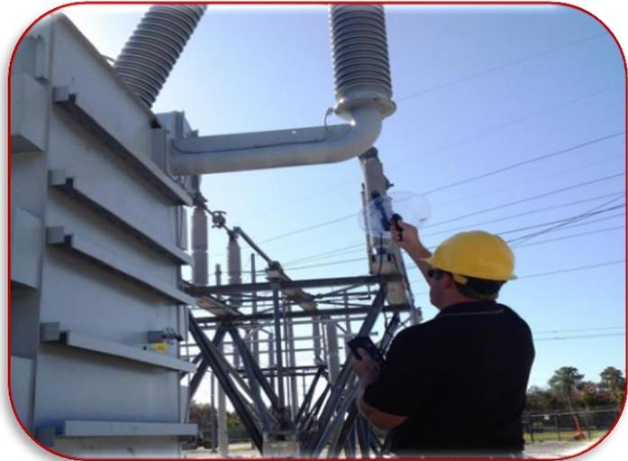
Das ULD-40 Instrument ermöglicht, das konvertieren von Ultraschall zum hörbaren Frequenzbereich umzuwandeln. Der Corona Effekt führt bläuliches Licht auf der Oberfläche des Leiter oder auf der Isolierung eines Kabels, und ist von einem starken elektrischen Feld umgeben, zum Beispiel: Transformatordurchführung, Isolator, Überspannungsableiter usw.
