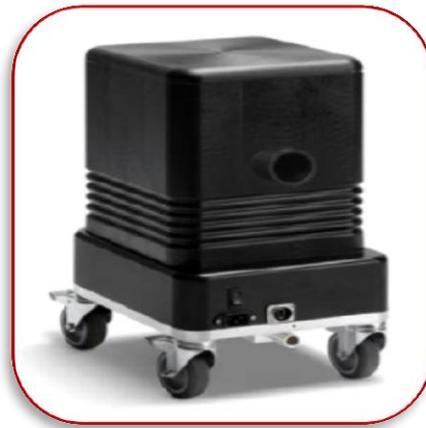
Als einfaches und äußerst effektives Verfahren zur Beurteilung und Bewertung des Alterungszustandes von Mittelspannungskabeln ist die Tangens Delta Messung die Methode zum Aufspüren von treeing in der Isolierung.
