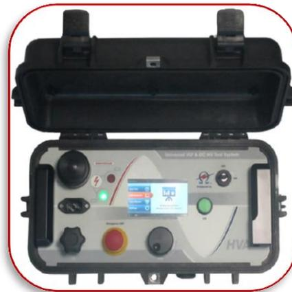
**Leistung** - das M-VLF28 bietet herausragende Eigenschaften in Bezug auf Größe, Gewicht (14 kg) und Leistung (max. 10  $\mu$ F). Das trockene Design (kein Öl) macht das Instrument nahezu wartungsfrei.
