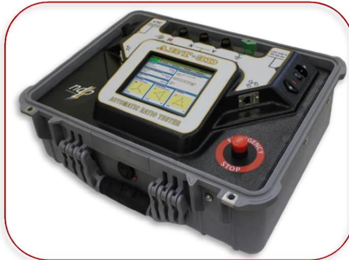
Das MART-3D ist ein Messgerät das mit hoher Genauigkeit die Windungsverhältnisprüfung von Leistungstransformatoren (Hoch/Spannung oder Strom) durchführt. Ziel ist es um zu erkennen ob Abweichungen in der Isolierung zwischen Windungen, den Wicklungen und der zentralen Lage oder Verformung der Wicklungen auf dem Kern vorliegen.
