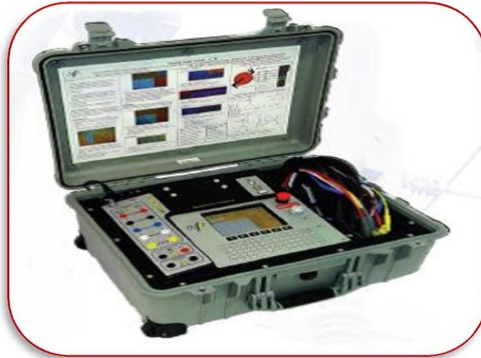
Die CTT misst den Sättigungsspannungs Level nach (IEEE30, IEEE45 und IEC-10/50), das Verhältnis, die Polarität, die Phasenverschiebung zwischen primären und sekundären, Fehler in Prozent zwischen der Messung und dem Leistungsschild, Erregerstrom, Widerstand der Wicklung, Isolationswiderstand und die Belastung durch Impedanz. Die CTT ermöglicht die manuelle oder automatische Prüfung.
