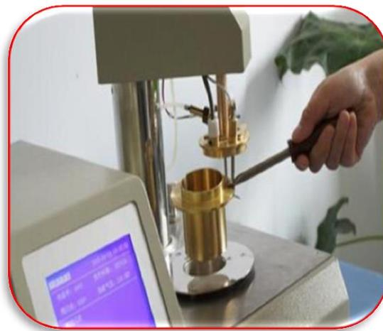
Vollautomatischer Flamm- / Brennpunkt Tester
