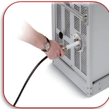
Das M-VLF 90 ermöglicht das Prüfen von Kabeln mit bis zu 3.300 m Länge (bei 1  $\mu$ F - 0,1 Hz und 64 kV rms). Durch die variable Ausgangsfrequenz können jedoch wesentlich längere Kabelstrecken geprüft werden. Bei 10  $\mu$ F - 0,01 Hz und 64 kV rms eine Länge von ca. 33.000 m
