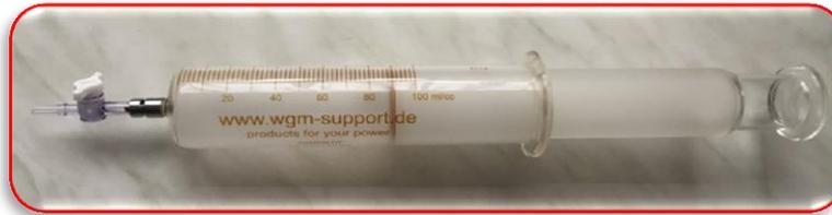
Die Glasspritzen mit Metallkonus haben einen Luer lock Anschluss und sind aus Borosilikatglas. Die Spritzen sind geeignet für die DGA Untersuchung (Gas-in-Öl-Analyse). Die Glasspritze wird mit aufgedruckter brauner Graduierung geliefert sowie eine Stempelprägung auf Gehäuse und Kolben. Die Spritzen sind säure- und laugenbeständig. Lieferbar in verschiedenen Ausführungen von 1ml bis 200ml.
